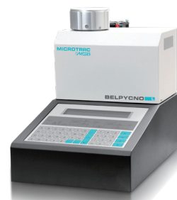
真密度測定装置（大容量仕様） BELPYCNO L
