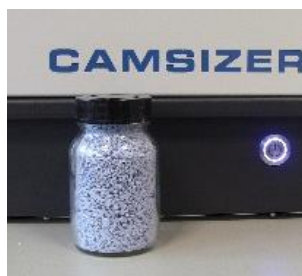
Abb. 2: Eine Probe extrudierter Katalysatoren. Der CAMSIZER 3D Bildanalysator vermisst 250 ml in 3 Minuten, Handmessung mit der Schieblehre analysiert ca. 200 Partikel pro Stunde.
