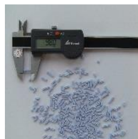
Abb. 2: Eine Probe extrudierter Katalysatoren. Der CAMSIZER 3D Bildanalysator vermisst 250 ml in 3 Minuten, Handmessung mit der Schieblehre analysiert ca. 200 Partikel pro Stunde.
