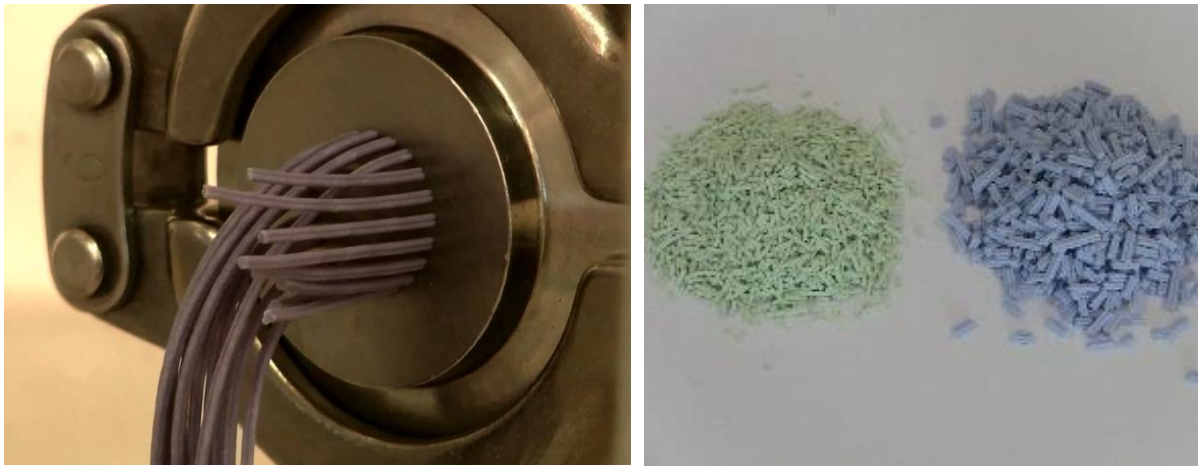
Abb. 1: Links: Herstellung von Extrudaten (Bild: https://www.caleva.com/knowledge-base/extruding-catalyst-materials-for-petrochemical-and-adsorption-products ) Rechts: Typische extrudierte Katalysatoren.
