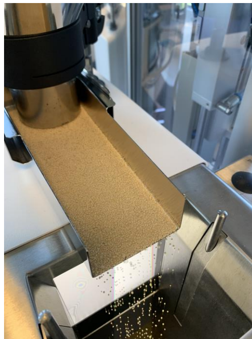
Abb. 1: Kalksteinpellets während der Messung mit dem CAMSIZER 3D.
