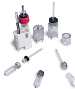
Dilatometer in verschiedenen Größen zur Messung von porösem Material
