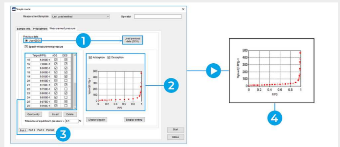
1. 加载现有等温线 | 2. 显示预期等温线 | 3. 测量范围输入 | 4. 自动优化条件，例如气体引入量 |
