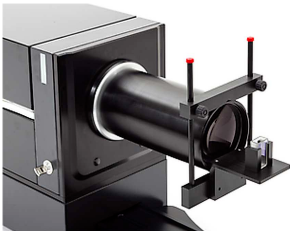
Mokrú meranie pomocou dávkovej bunky
