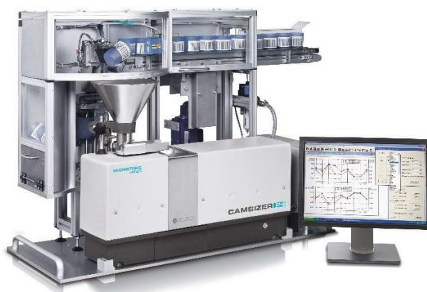
図6：オートサンプラーを搭載したCAMSIZER P4
