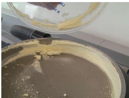
図7：1分間のエアジェットシーブ後、 63μm目開きふるい上のパウダークリーム
