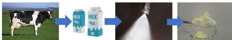
図1：スプレードライで粉ミルクやパウダークリームを製造。脂肪分が多いため、粉体は凝集体となりやすい。
